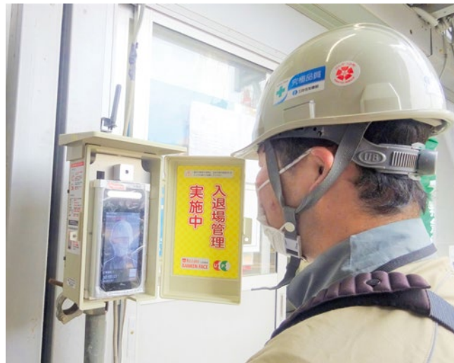
CCUS (建設キャリアアップシステム)の顔認証システムで入退場を管理している
