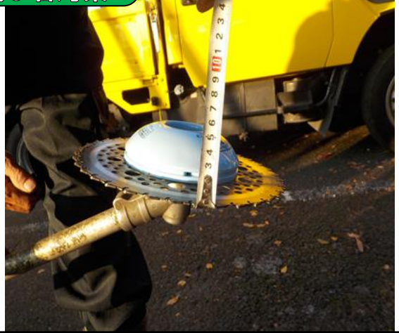
地面と刈刃のクリアランスを確保する アタッチメントの装着
