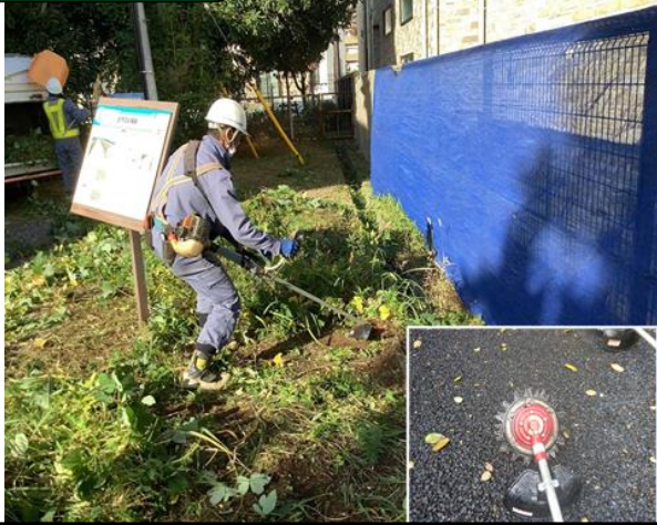
上下刃逆回転ハサミ切型 アタッチメントの使用
