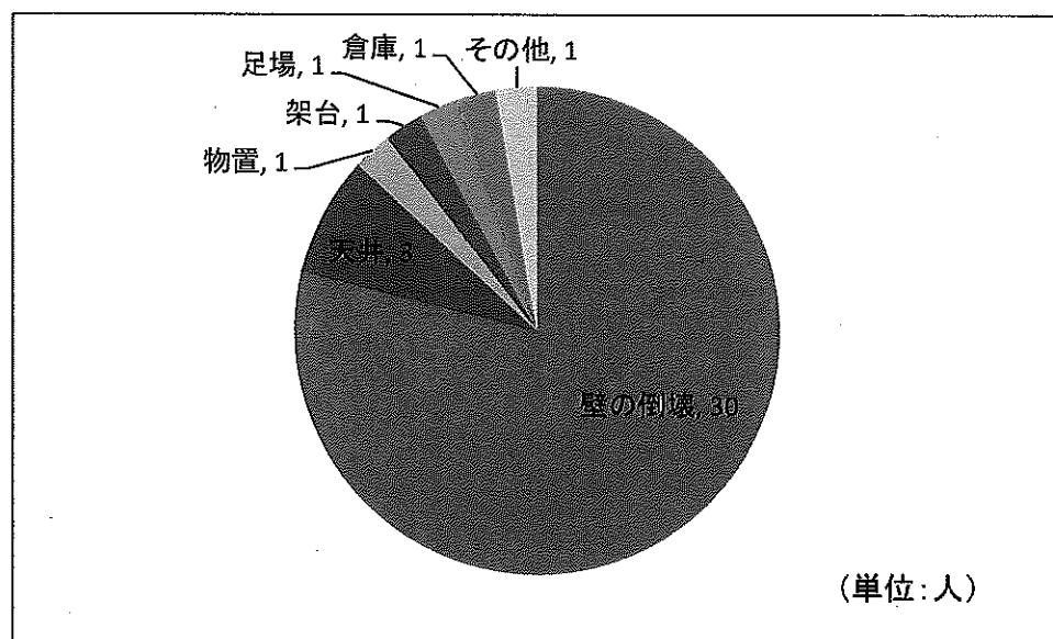
図4 「崩壊、倒壊」災害における起因物
