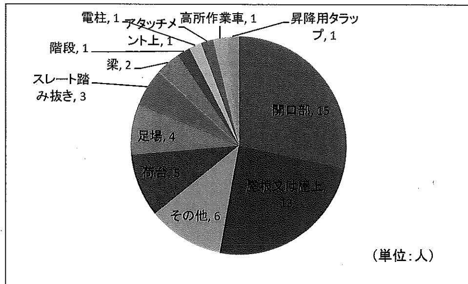
図3 「墜落、転落」災害における墜落箇所
