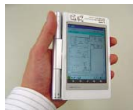
図 5-4-3 仕上検査システム (レンタルのニッケン)
